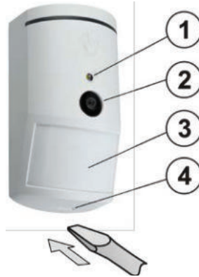
Abbildung: 1 – Blitz für Beleuchtung; 2 – Kameralinse; 3 – Linse des PIR-Melders; 4 – Abdeckungsplatte;
