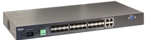
Dieser Layer-2/3 Switch mit weitreichenden L3-Funktionen wurde eigens für Anwendungen mit hoher Datenlast, wie z.B. Video over IP, Video streaming auch in Verbindung mit Multicast entwickelt. Durch die hohe Anzahl an optischen Ports eignet sich der RY-LGSO25-24 speziell für die Anbindung von abgesetzten Standorten, wie z.B. IP-Kameras. Mit den weitreichenden Managementmöglichkeiten lassen sich auch komplexe Netzwerkanforderungen erfüllen.
