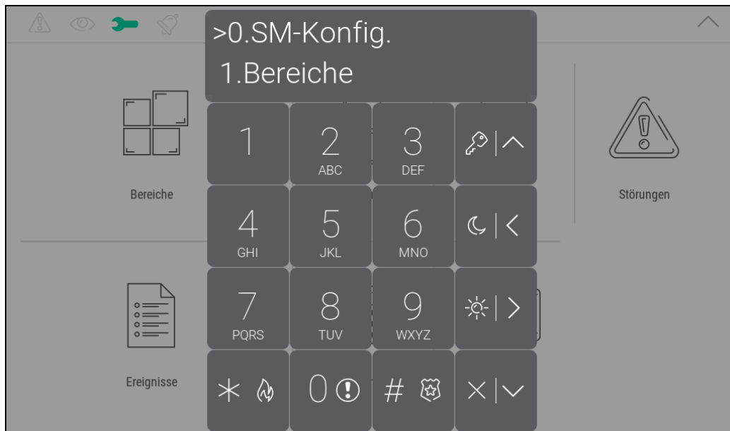
Abb. 22. Tastaturfeld mit angezeigtem Servicemenü.
